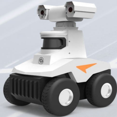
光伏电站巡检机器人
